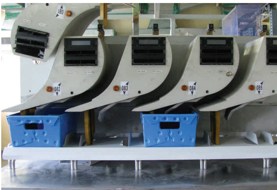
Postes Canada a mis à l'essai, à Toronto, le prototype des nouveaux conteneurs sur une machine à trier les grands objets plats.
